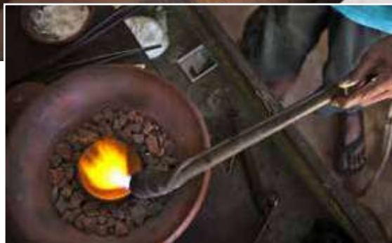
Atas: Di Sekotong, penambang menambahkan merkuri cair untuk pengendapan dalam gelundung. Serbuk emas menempel dengan merkuri dan membentuk amalgam padat. Merkuri yang berlebih dalam endapan yang dibuang, masuk ke saluran air setempat. Insert: Pemanasan amalgam menguapkan merkuri dan meninggalkan butiran emas.
