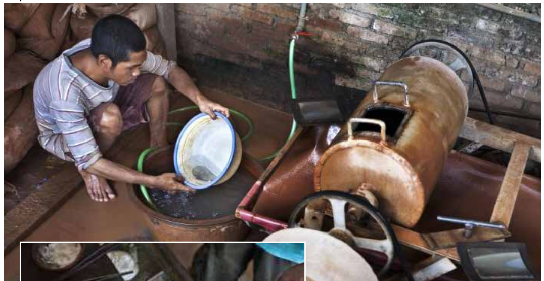
Atas: Di Sekotong, penambang menambahkan merkuri cair untuk pengendapan dalam gelundung. Serbuk emas menempel dengan merkuri dan membentuk amalgam padat. Merkuri yang berlebih dalam endapan yang dibuang, masuk ke saluran air setempat. Insert: Pemanasan amalgam menguapkan merkuri dan meninggalkan butiran emas.
