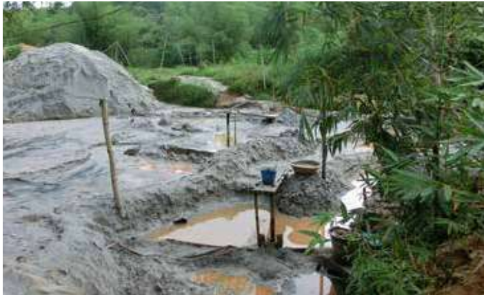
Atas: Selama proses penambangan emas skala kecil, beberapa merkuri tertinggal di lumpur (dikenal sebagai tailing tambang). Merkuri berlebih ini sering terbuang di sekitar saluran air ketika tailing dibuang. Kiri: Pekerja membersihkan bijih sinabar untuk diolah menjadi merkuri.
